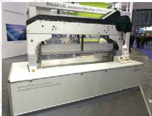
配备de82/de83提综机构的LXL多臂机
