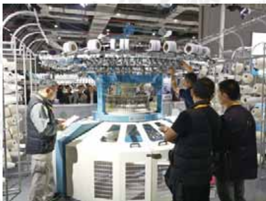
现场生产空气层面料的A□□□A□双面针织机
