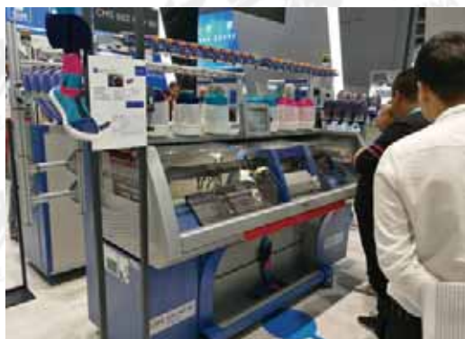
CMS 330 HP W TT Sport 多针距机型现场编织鞋面产品
