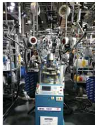
□A□□极细针距袜机现场生产超薄裸氨丝袜产品
