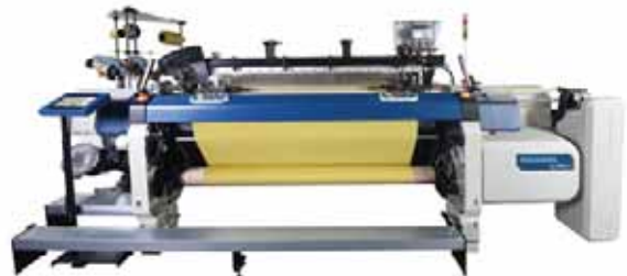
用于织造对位芳纶面料的OptiMax-i剑杆织机
