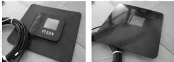
图1 集成感应器和电源的渗漏监控模块
