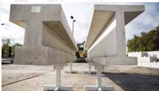
图5 由钢材（左）和碳纤维混凝土制成的同等强度的双T型梁
