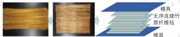
图3 竹原纤维/PP复合材料制备示意图
